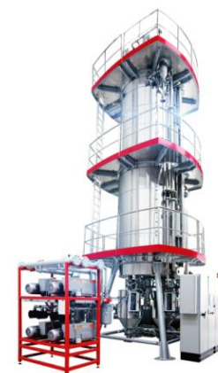
Wieża SSP (do dekontaminacji płatków rPET)
