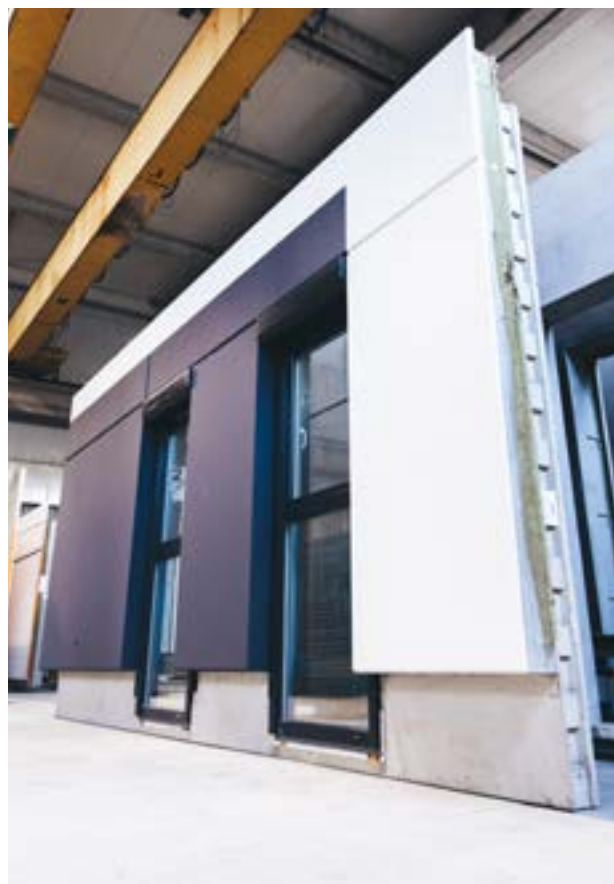
Ściana prefabrykowana trójwarstwowa, Poznań
