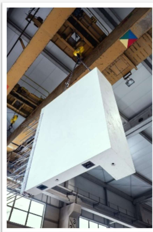
Element z białego betonu architektonicznego na osiedle Am Tacheles, Berlin
